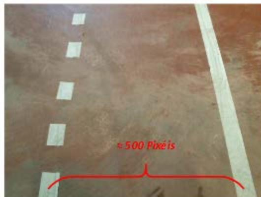
Figura 4.36 - Largura da faixa de rodagem à resolução de 640x480 *pixéis*
