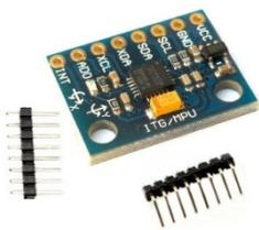
Figura 2.29 - Acelerómetro e Giroscópio Digital
