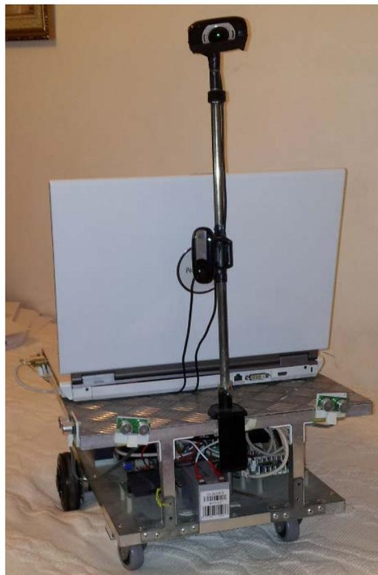
*Figura 4.1 - Robot móvel desenvolvido*
