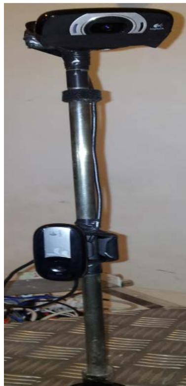
Câmara Destinada à Detecção da Faixa de Rodagem
