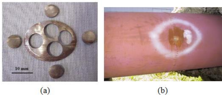
Figura 2. 50 - (a) Provetes SP obtidos a partir de uma amostra recolhida SSam TM-2 [36]. (b) Zona da extração da amostra [37].
