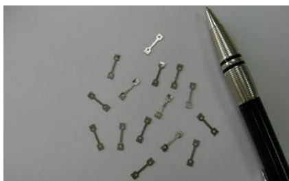
Figura 2. 12 - Comparação do tamanho do provete de ECSSU com uma caneta [14].
