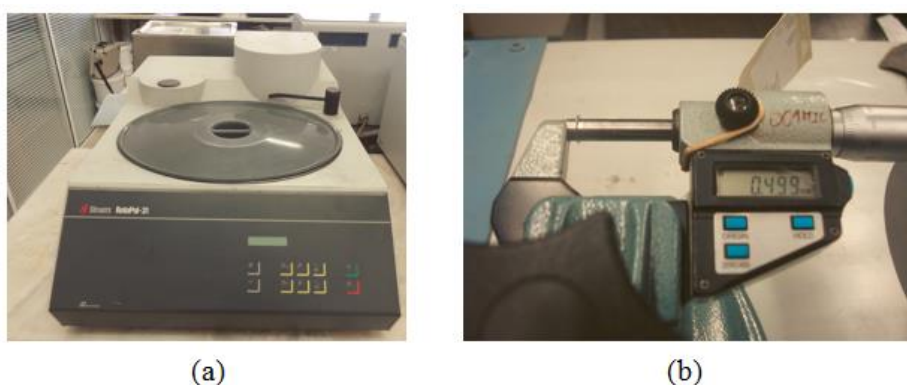
Figura 5. 6 - (a) Máquina de polir. (b) Micrómetro utilizado para o controlo dimensional da espessura.
