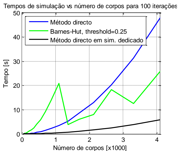
Figura 6.11 - Comparação entre os tempos de simulação do método direto e método de Barnes e Hut em linguagem C e tempo de simulação com o sistema de hardware desenvolvido.
