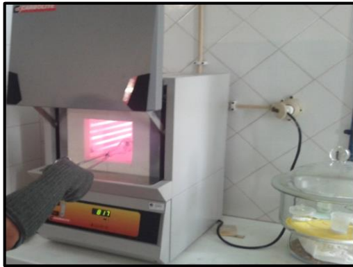
Figura 3.25 - Colocação dos cadinhos na mufla
