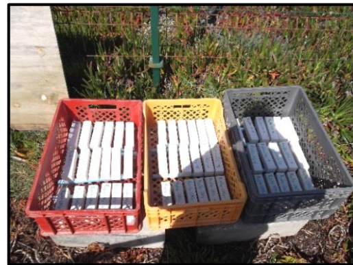
Figura 3.8 - Provetes em ambiente marinho
