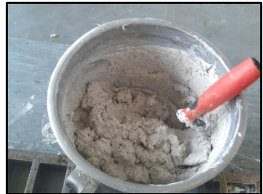
Figura 3.12 - Homogeneização manual da argamassa
