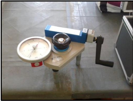
Figura 3.49 - Acessório de Arrancamento
