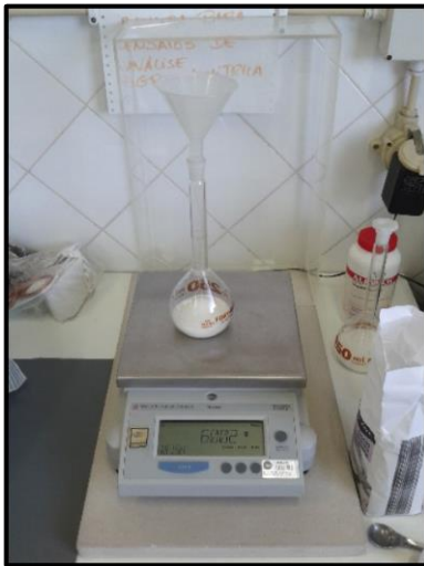
Figura 3.31 - Pesagem da sacarose
