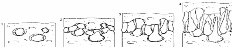
Figura 2.7 - Desenvolvimento do processo de cristalização (Silveira, 2008)
