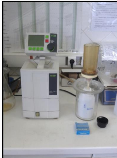
Figura 3.32 - Filtragem a vácuo
