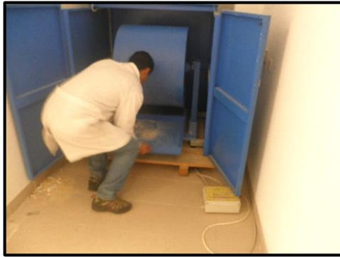
Figura 3.3 - Máquina de Ensaio de Desgaste de Los Angeles
