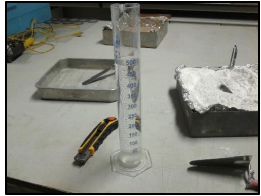
Figura 3.10 - Medição da quantidade de água de amassadura
