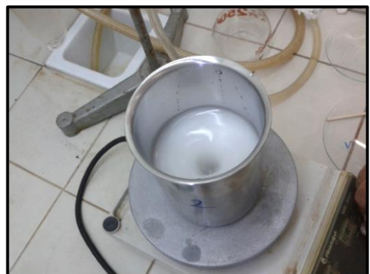
Figura 3.28 - Agitação da solução
