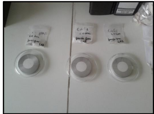
Figura 3.24 - Amostras para difração
