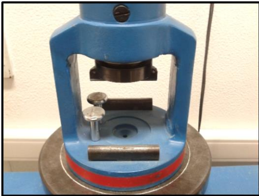
Figura 3.40 - Apoios para o ensaio de flexão
