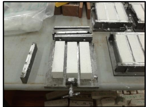
Figura 3.16 - Desmolde dos provetes
