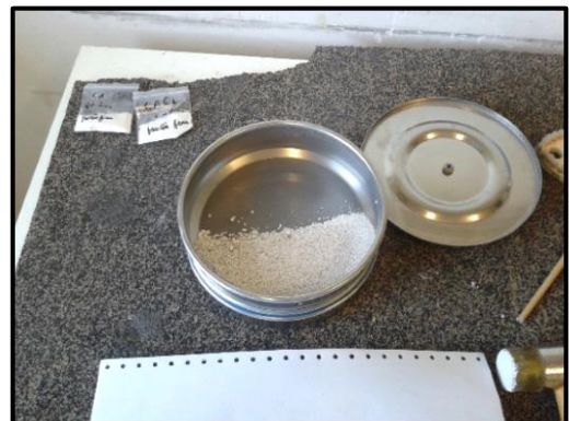
Figura 3.22 - Passagem pelo peneiro de 106 \mu\text{m}
