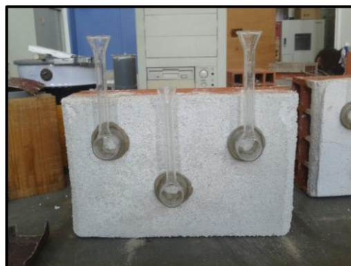
Figura 3.52 - Fixação dos tubos de Karsten
