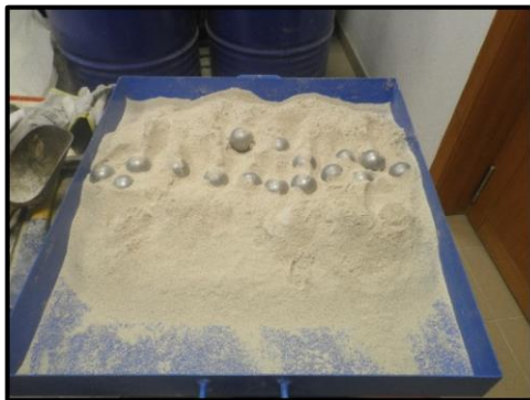
Figura 3.5 - Resíduo após os ciclos de desgaste
