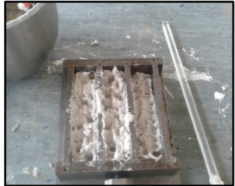
Figura 3.14 - Enchimento até meio e compactação
