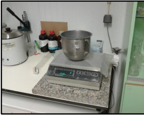
Figura 3.9 - Pesagem dos constituintes sólidos
