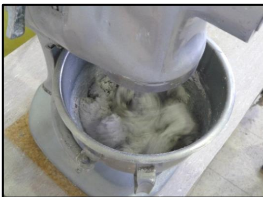
Figura 3.11 - Homogeneização mecânica da argamassa
