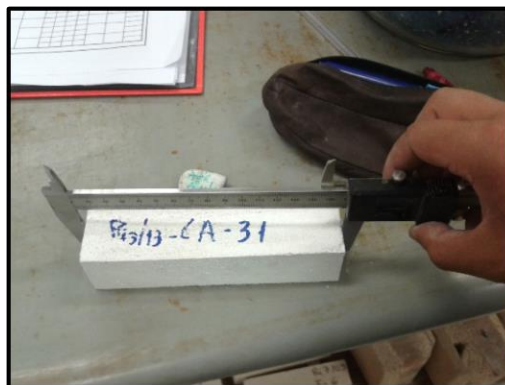
Figura 3.35 - Medição da dimensão longitudinal
