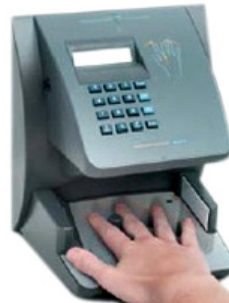
(d) Hand palm scanner for person identification [8].
