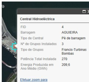
Figura 5.24 - Central hidroelétrica.
