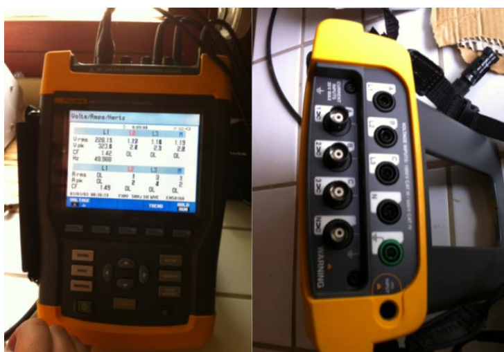
Figura 5.11: Analisador de qualidade de energia FLUKE 435.
