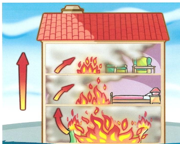
Figura 5 – Propagação do fogo por convecção (Fonte: Prosegur Tecnologia – Novos Horizontes da Segurança )
