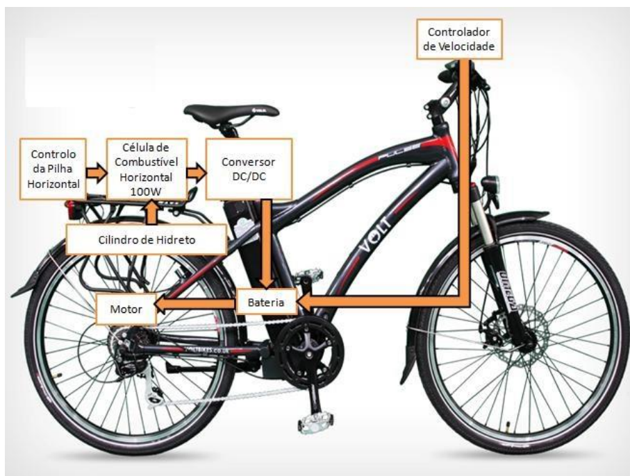
Figura 18 - Esquema exemplificativo do sistema na bicicleta elétrica (Modelo HMX) [13]
