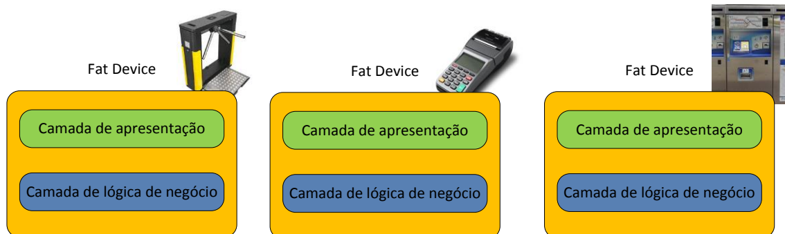
Figura 1 – Exemplo de três arquiteturas "fat device".
