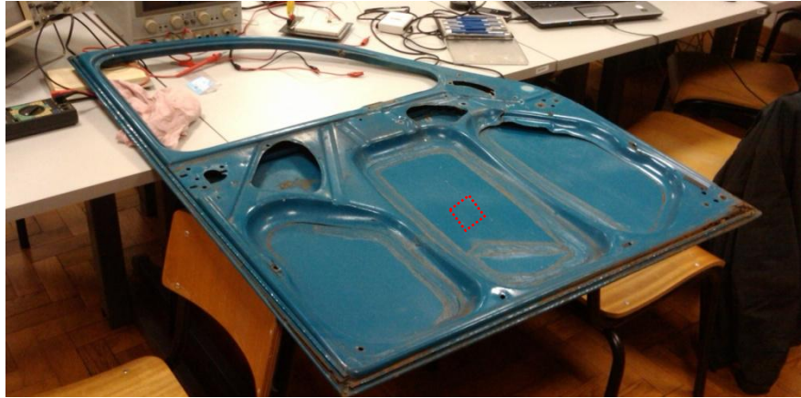
Figura 3.8 – Porta utilizada nos ensaios laboratoriais, com marcação do local onde o sensor ficou instalado
