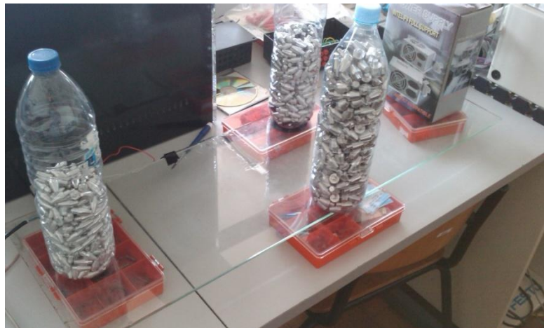
Figura 3.9 – Para-brisas apoiado em 4 pontos e sensor piezo elétrico instalado
