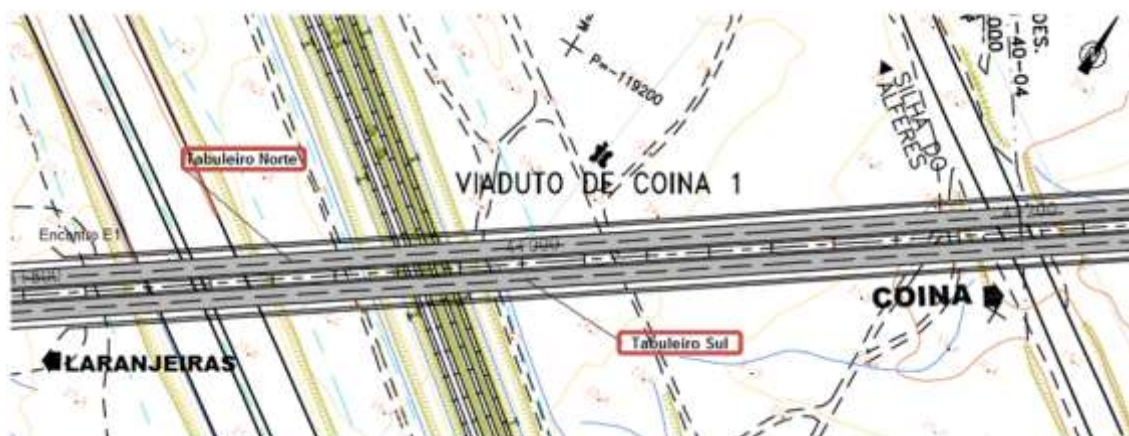
Figura 20 - Tabuleiro Norte e Sul do Viaduto Coina 1
