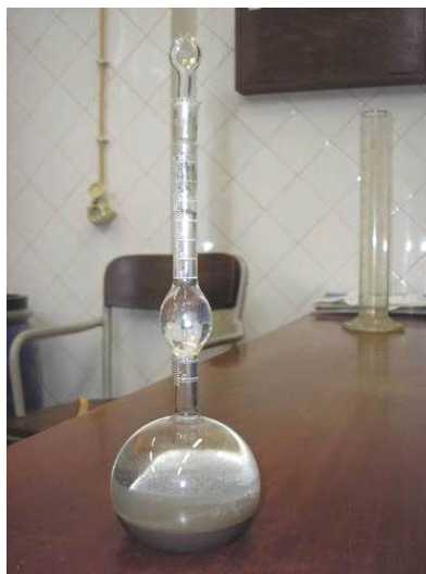
Figura 29 – Determinação da massa volúmica do cimento
