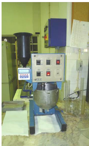
Figura 31 – Misturadora automática utilizada nas amassaduras.
