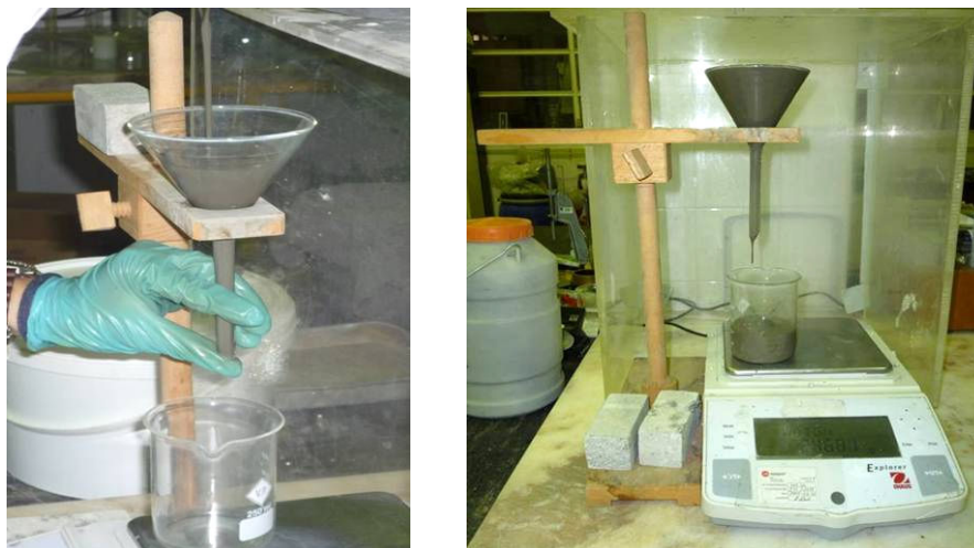
Figura 34 – Ensaio de escoamento.
