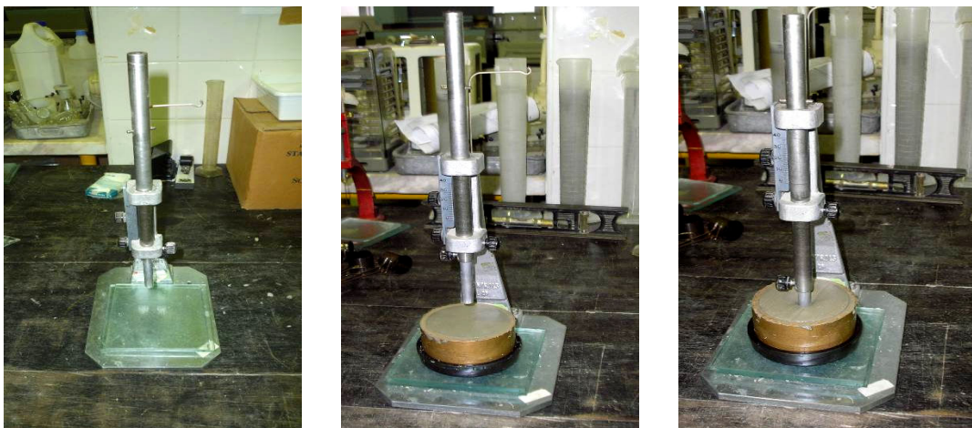
Figura 26 – Ensaio para a determinação da consistência normal do cimento.
