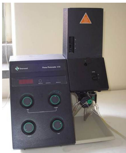
Figura 42 – Fotômetro de chama Sherwood modelo 410.
