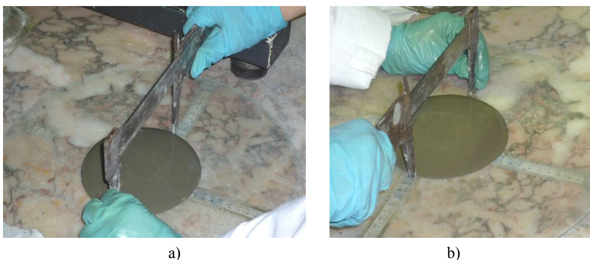
Figura 36 – Ensaio de espalhamento, (a) medição do diâmetro na horizontal, (b) medição do diâmetro na vertical.
