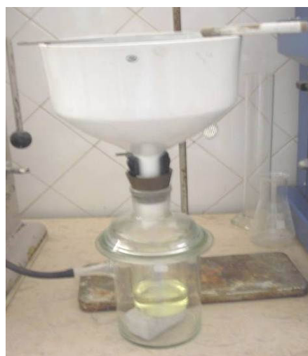
Figura 38 – Montagem para obtenção da fase solúvel da pasta
