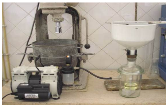
Figura 38 – Montagem para obtenção da fase solúvel da pasta
