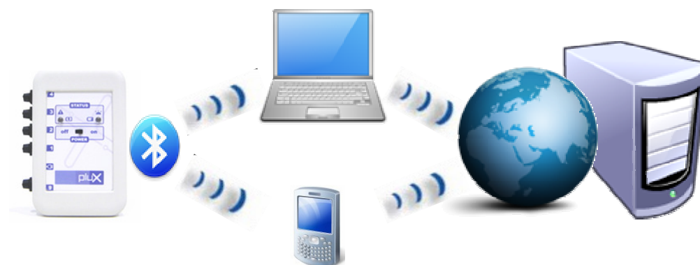
Figura 13 – Envio do sinal ECG pelo BioPLUX para um dispositivo móvel que redireciona para o sistema biométrico através da Internet.
