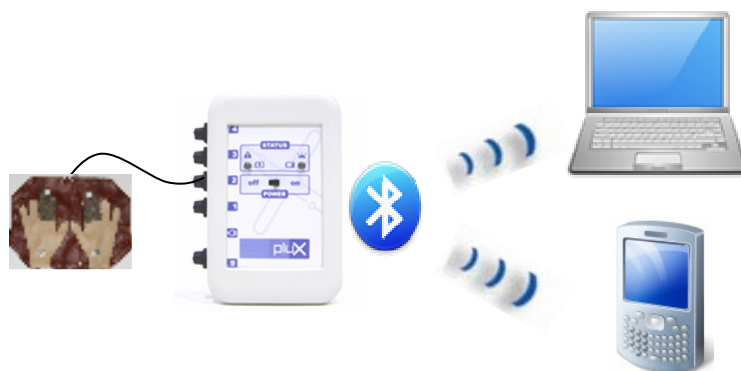
Figura 12 – Aquisição do sinal biométrico ECG nas palmas das mãos através do dispositivo BioPLUX .
