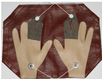
Figura 37 – Imagem do setup utilizado para a aquisição de sinais ECG.
