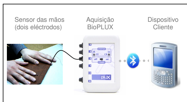
Figura 36 – Aquisição do sinal ECG e envio para a aplicação cliente.
