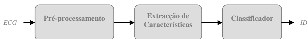
Figura 4 – Estrutura clássica de um sistema de reconhecimento de padrões aplicado ao problema da identificação.
