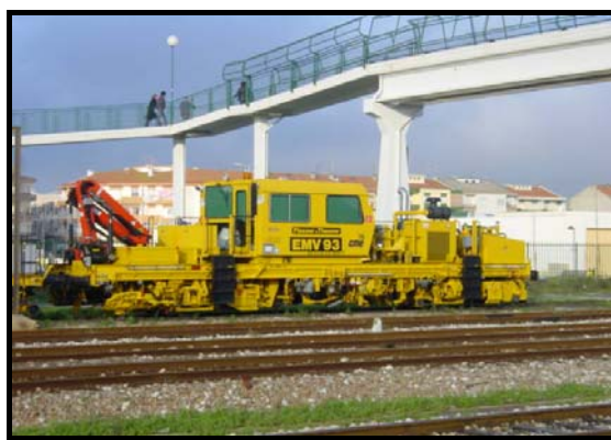
Figura XIV – Estabilizadora dinâmica de via. (GIBB Portugal)
