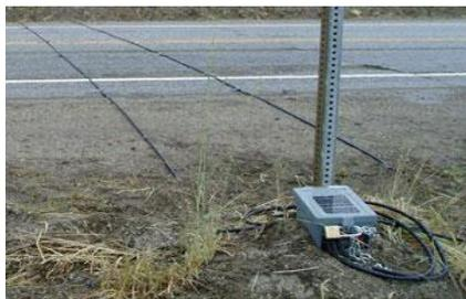
Contador de carros com sensor pneumático [2]
