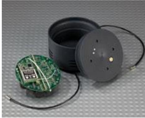
Fig. 2-5 Eq-sensor c/ Vehicle Magnetic Imaging, comunicações sem fios, alimentado por baterias [15]
