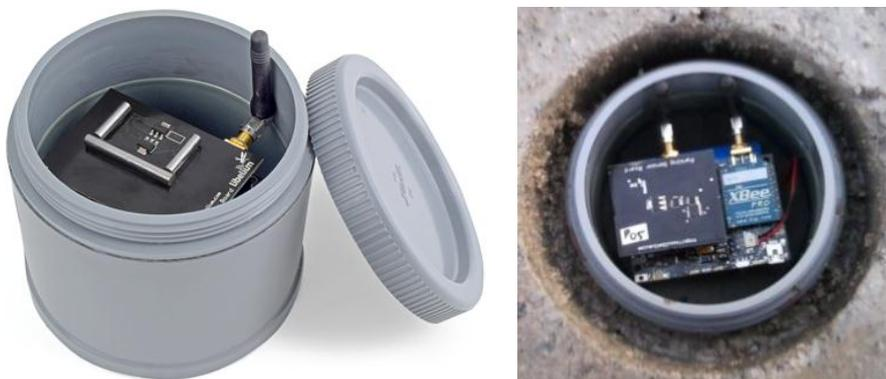
**Fig. 2-4 Eq-sensor c/ magnetómetro, comunicações sem fios, alimentado por baterias [14]**
