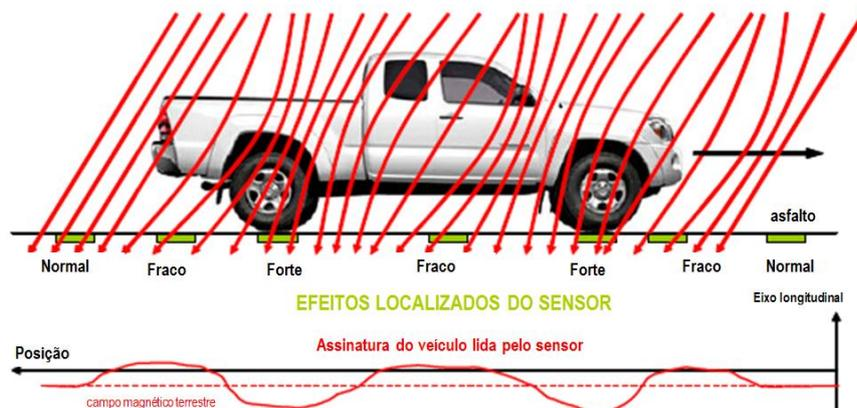
Fig. 3-3 Modificação do CMT pela passagem de um veículo [27]
