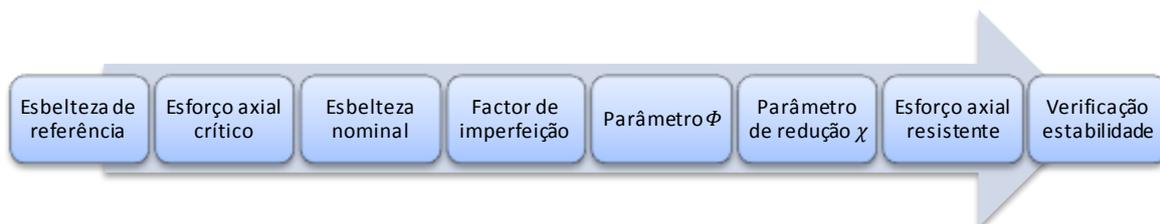
Figura 41 – Algoritmo para verificação de resistência à encurvadura devido a compressão.
