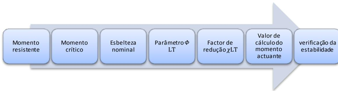
Figura 43 – Algoritmo para a verificação da resistência à encurvadura devido a flexão e torção.
