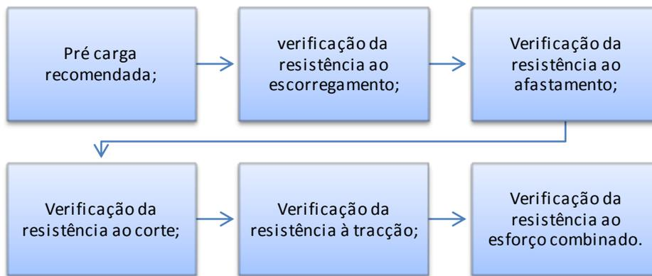
Figura 59 – Algoritmo para verificar a resistência mecânica de parafusos através do EC3 parte 1-8 (22).
