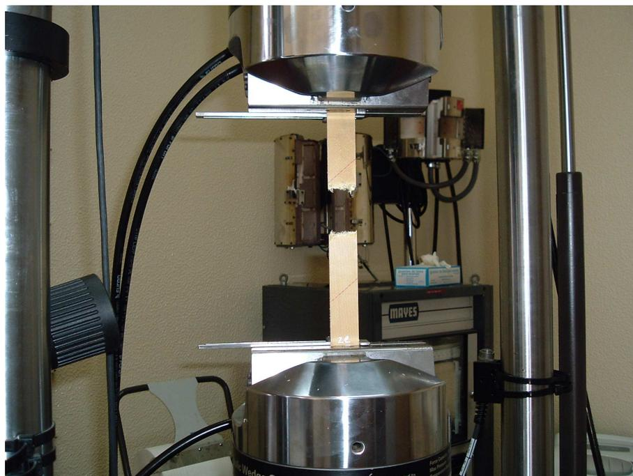
Figura III.3 - Ensaio de tracção num provete de laminado de Kevlar
