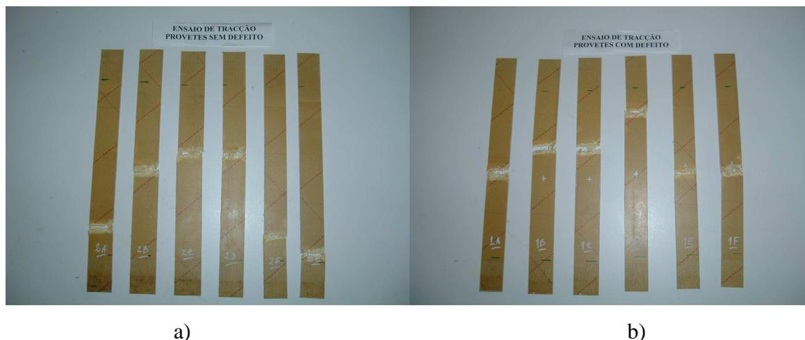
Figura III.6 - Provetes após ensaio de tracção: a) sem e b) com defeito
