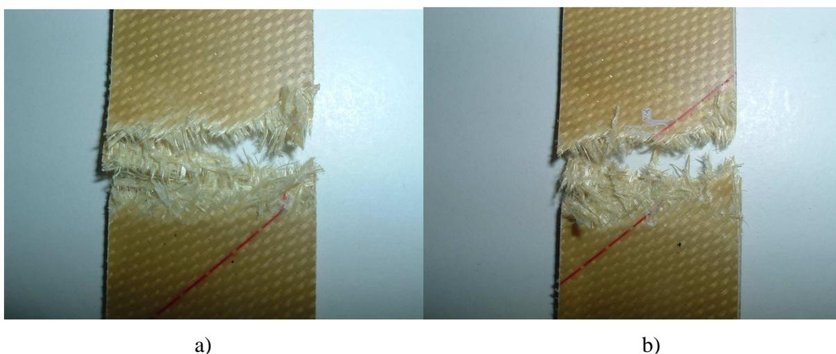
Figura III.7 - Pormenor da zona de fractura dos provetes 2B sem defeito (a) e 1A com defeito (b)
