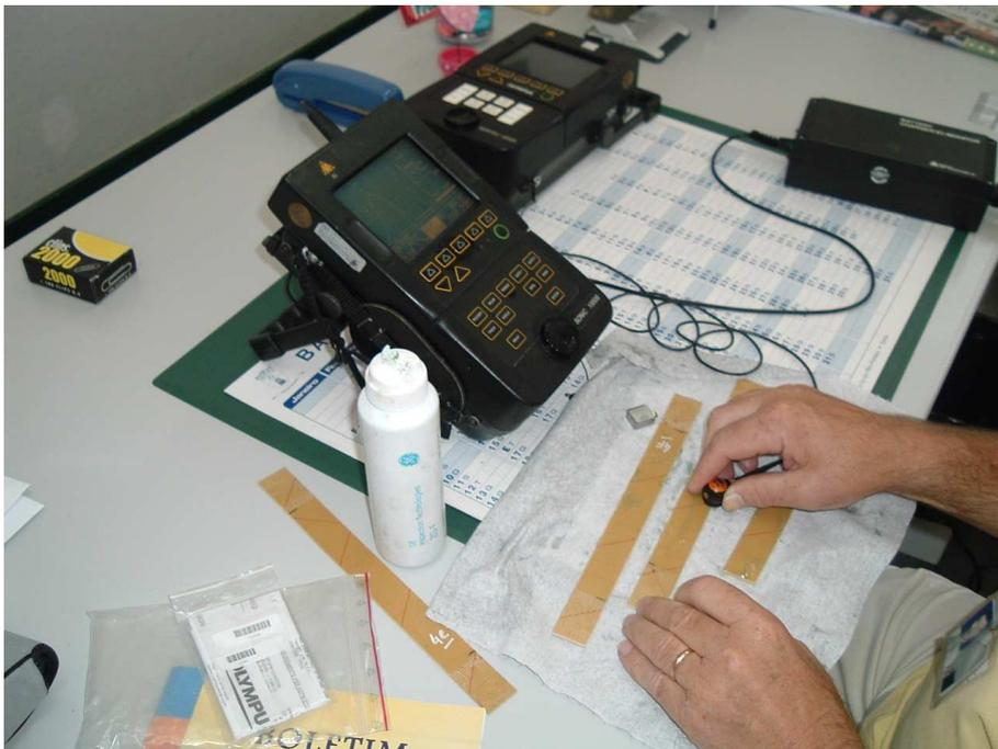
Figura III.17 - Teste ao provete com defeito por ultra-sons
