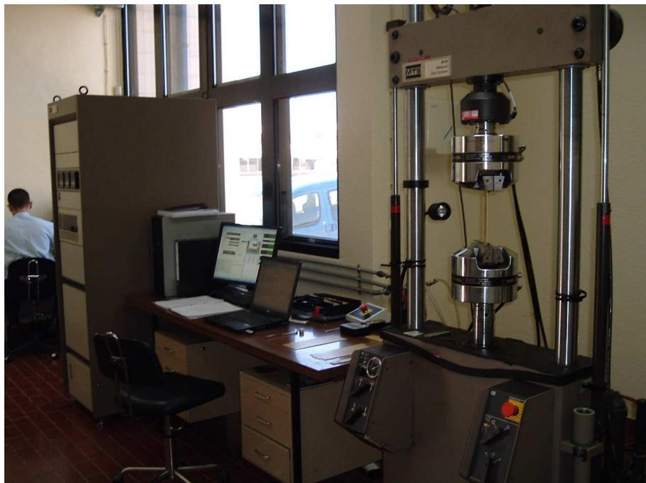
Figura II.19 - Máquina de ensaios MTS 810 (do Laboratório de Ensaios de Materiais da AFA)
