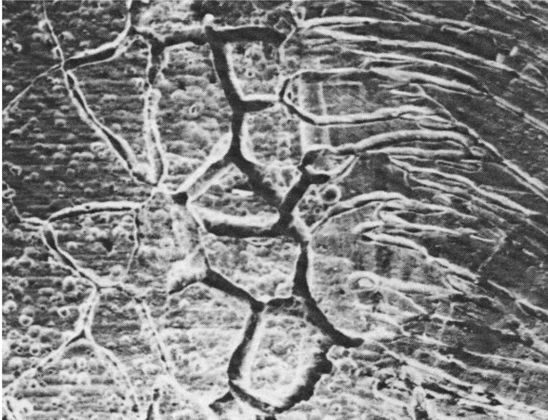
**Figura 2.6** Exemplo de Corrosão Intergranular [16]
