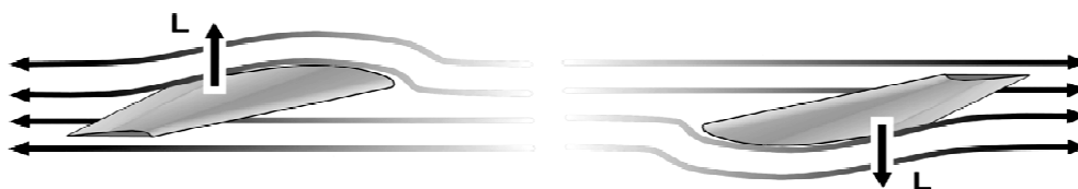
Figura 20 – Aerodinâmica das forças de sustentação (9) , http://wings.avkids.com acedido em 22/01/2010
