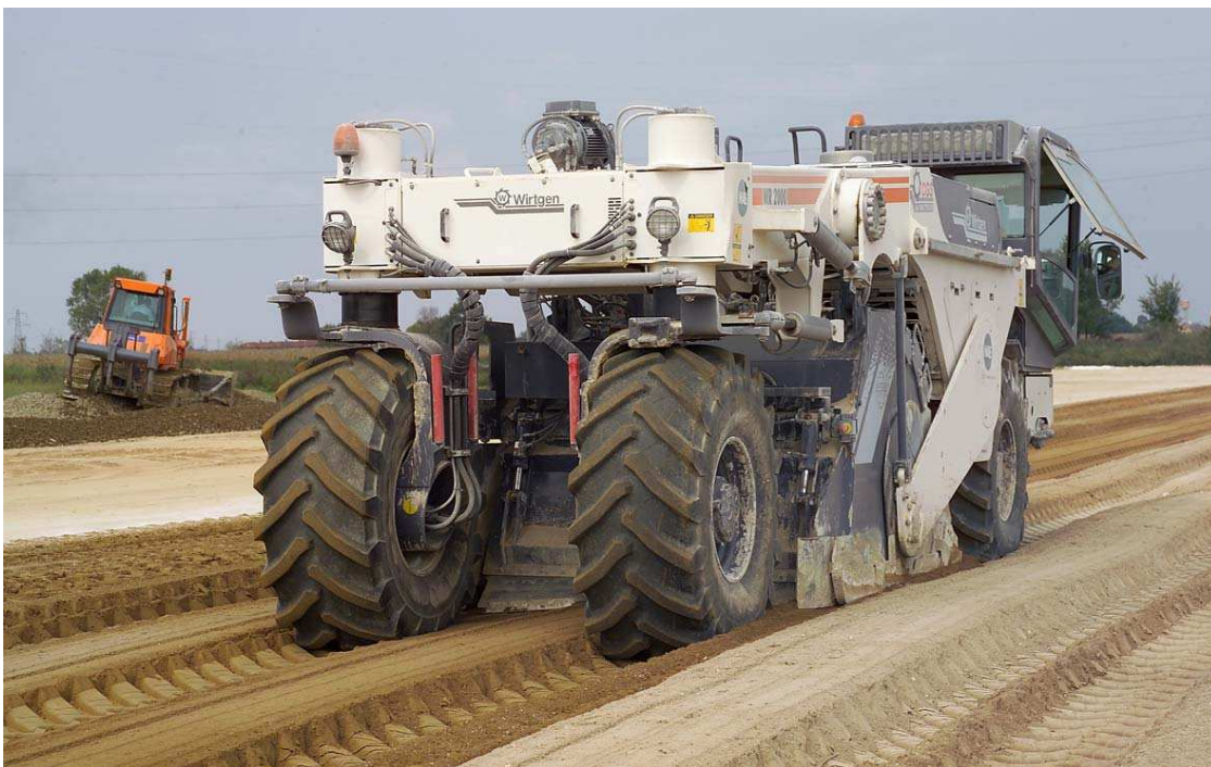
Fig. 25 – Recicladora Wirtgen WR 2000 (Wirtgen, 2007)
