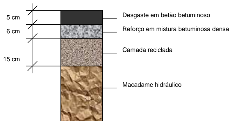
Fig. 39 – Estrutura final do pavimento reabilitado (EN-108 Porto/Entre-os-Rios)
