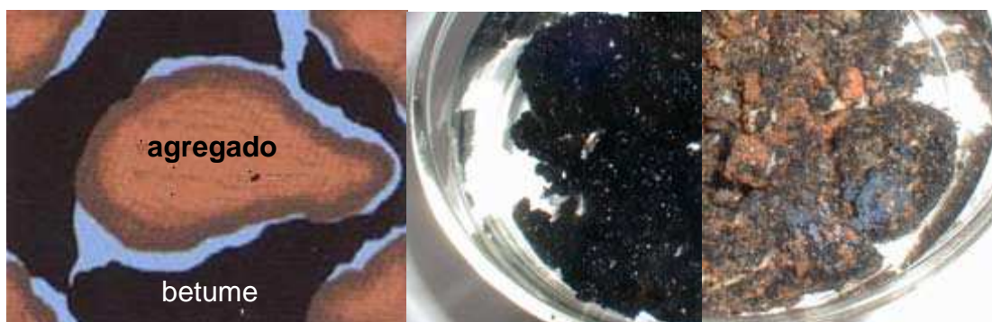
Fig. 9 – Deslocamento do filme betuminoso pela acção da água (Liberatori e Constantino, 2006)
