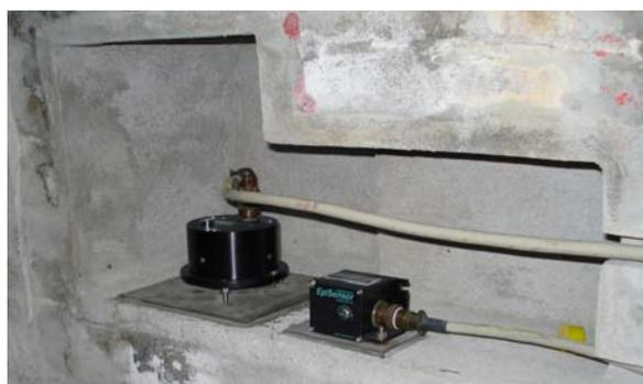
**Figura 2.9:** Disposição dos acelerómetros num nicho de uma galeria de uma barragem de betão.
