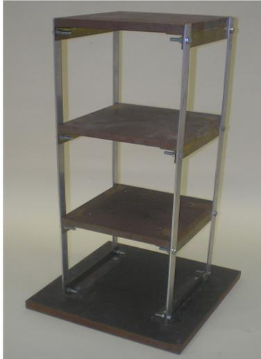
**Figura 3.20:** Modelo físico de um edifício de 3 pisos.
