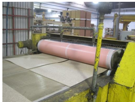
Figura 63 – Colocação de cola na placa de aglomerado
