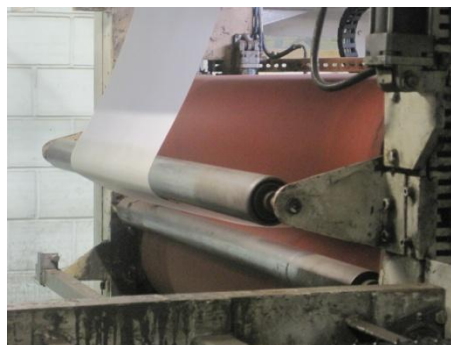
Figura 86 – Aplicação do revestimento
