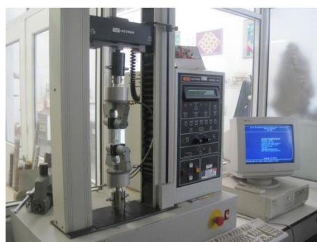
Figura 125 – Controlo da resistência da colagem do revestimento sobre o material
