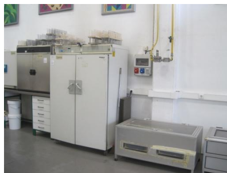
Figura 120 – Estufas de controlo de humidade
