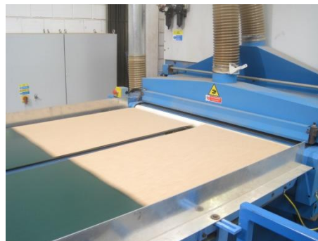
Figura 78 – Material à saída da lixagem
