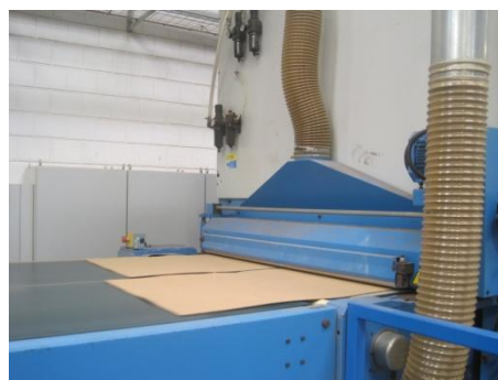
Figura 76 – Material à saída da lixagem
