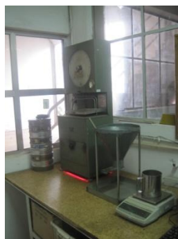
Figura 48 – Sistema de controlo da trituração efectuada hora a hora
