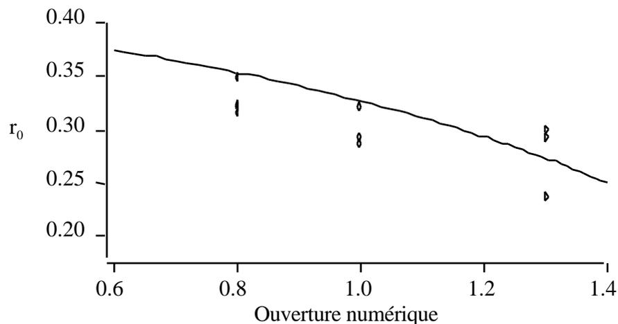
**Figure IV. 17 :** Dépendance de l'anisotropie initiale,  $r_0$ , en fonction de l'ouverture numérique de l'objectif. Les données expérimentales (symboles) correspondent à des mesures effectuées sur la Rd6G dans le butanol (objectif x100). La courbe théorique (ligne) provient du traitement mathématique effectué par D. Axelrod (1979).
