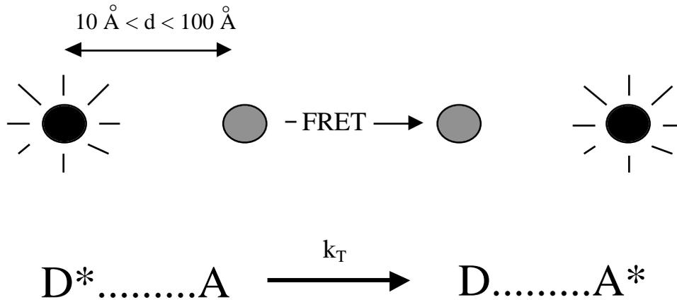
**Figure II. 6 :** Le FRET vu comme réaction chimique. C'est la réaction transformant les espèces donneur excité ( $D^*$ ) et accepteur ( $A$ ) vers les espèces donneur ( $D$ ) et accepteur excité ( $A^*$ ) qui caractérise le transfert d'énergie. A cette réaction correspond la constante cinétique  $k_T$ , vitesse de transfert.
