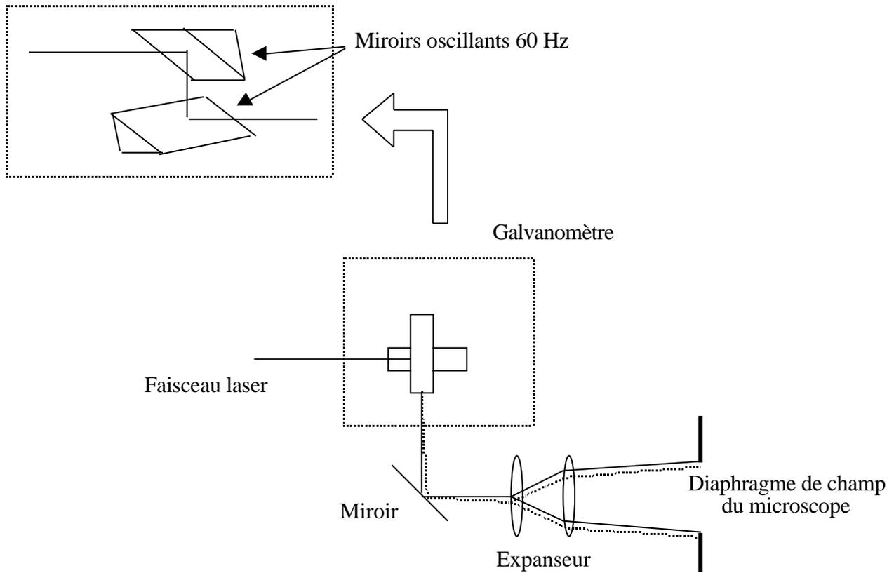
**Figure IV. 2 :** Schéma du galvanomètre avant l'expansion du faisceau laser à l'entrée du microscope. Le galvanomètre déplace à une fréquence de 60 Hz le faisceau laser de quelques millimètres à l'entrée de l'expenseur de faisceau.
