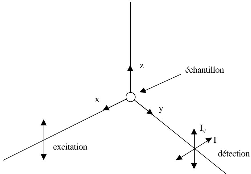
**Figure II. 13 :** Représentation géométrique de la mesure d'anisotropie.
