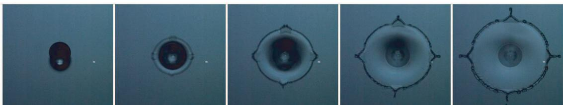
FIG. 5.57: Vue aérienne d'un impact de goutte d'eau lâchée de 85 cm de haut ( $V = 3.7$  m/s,  $R_0 = 1.15$  mm,  $p = 10$   $\mu$ m,  $h = 36$   $\mu$ m). Les images, réalisées avec une caméra Phantom, sont espacées de 212  $\mu$ s. Ces images permettent de détailler les premiers stades de l'évolution du bourrelet.
