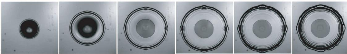
FIG. 5.48: Vue aérienne d'un impact de goutte d'eau lâchée de 20 cm de haut ( $V = 1.9$  m/s,  $R_0 = 1.9$  mm,  $p = 20$   $\mu\text{m}$ ,  $h = 36$   $\mu\text{m}$ ). Les images sont espacées de 1 ms. Une instabilité semble apparaître dans les directions du réseau carré.
