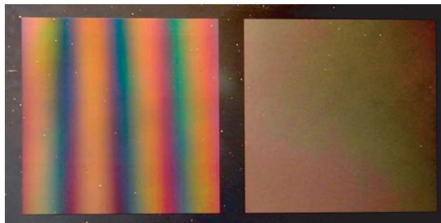
FIG. 2.10: Photographies des surfaces texturées. La surface irisée est composée de plots régulièrement espacés sur un réseau carré de 10  $\mu\text{m}$  de pas (figure 2.11a) alors que la surface diffuse est constituée d'un arrangement aléatoire de plots (figure 2.11b). Les deux surfaces ont exactement la même densité surfacique moyenne et la même rugosité. Chaque surface est un carré de 1.5 centimètres de côté.
