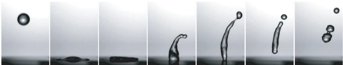
FIG. 6.20: Vue de côté d'un impact de goutte d'eau (de rayon  $R = 1.15$  mm) tombant de 25 cm de haut sur une surface à gradient de plots ( $d\phi_s/dx = 5.8$  %/mm). La vitesse d'impact est de 2.2 m/s. On constate que le rebond s'effectue de manière oblique. Les images sont espacées de 4 ms.
