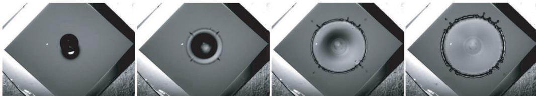
FIG. 5.31: Vue aérienne d'un impact de goutte d'eau lâchée de 30 cm de haut ( $V = 2.3$  m/s,  $R_0 = 1.9$  mm,  $p = 10$   $\mu\text{m}$ ,  $h = 18$   $\mu\text{m}$ ). Les images sont espacées de 1 ms. Les 4 petits jets sont éjectés dans les directions principales du réseau carré.
