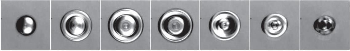
FIG. 5.7: Vue aérienne d'un impact de goutte (de rayon  $R = 1.15$  mm) tombant sur une surface microtexturée constituée de plots de  $10\ \mu\text{m}$  de haut, à la vitesse  $V = 1.1$  m/s, juste au-dessus de la transition de piégeage partiel. Les images sont prises toutes les millisecondes. Le pas du réseau vaut  $10\ \mu\text{m}$ .
