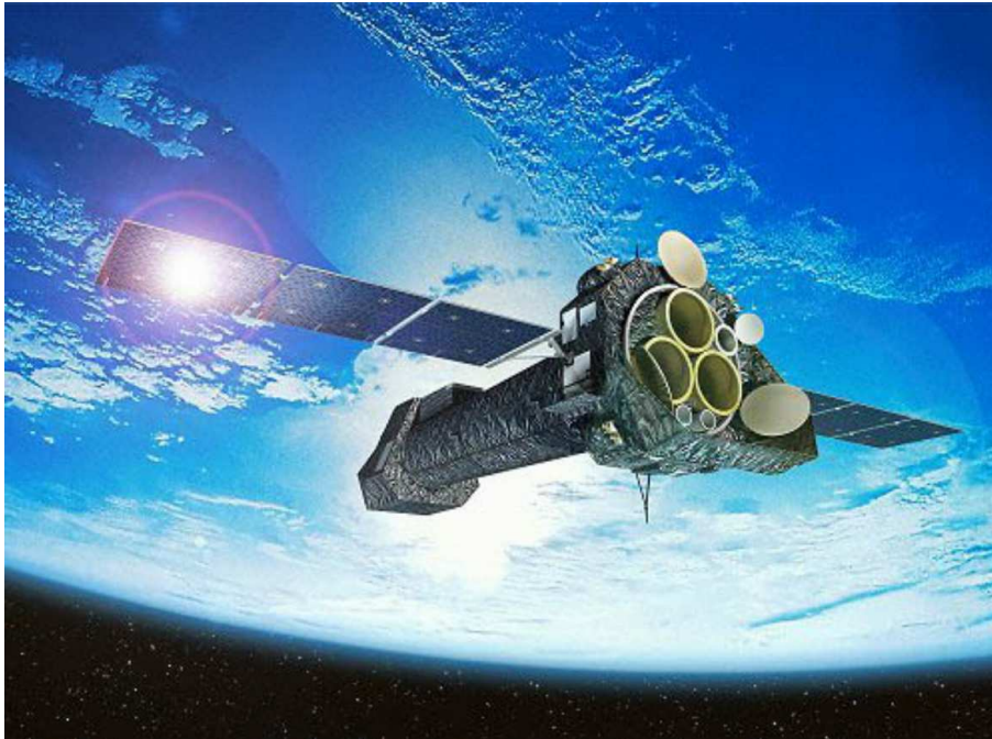
FIG. IV.5: Vue d'artiste du satellite XMM-Newton. On distingue facilement les trois télescopes chacun composé de 58 miroirs qui focalisent les rayonnements X par incidence rasante sur les instruments EPIC et RGS. Le télescope menant à l'instrument OM se situe entre deux des télescopes X, ici en haut à droite. Source : ESA.
