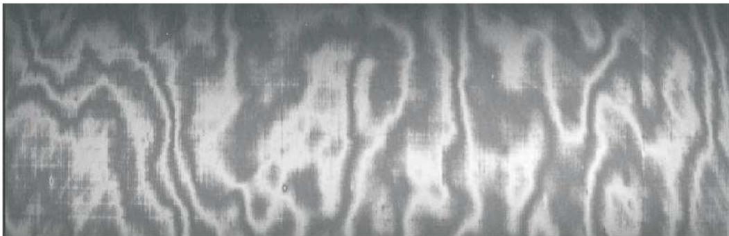
FIG. 2.3 – Figure d'interférences dues aux inhomogénéités d'épaisseur de la barrette CCD .
