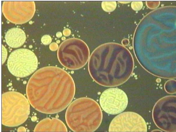
**Fig. 5.3:** Coexistence de domaines nématiques 6CB d'épaisseurs différentes. Taille de l'image environ  $500\ \mu\text{m} \times 400\ \mu\text{m}$  environ.
