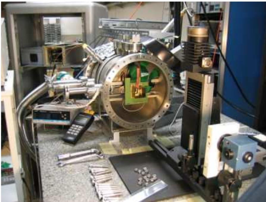
FIG. 3.1 – Vue d’ensemble du banc de test CCD lors de modifications : cryostat ouvert, plan focal, optique (table XY, sphère intégrante, obturateur).
