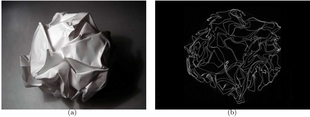
FIGURE 4.1 – (a) Boule de papier froissé : nous observons sur cette image des points et des lignes au niveau desquels se localise la déformation. (b) Tomographie par rayons X d'une feuille d'aluminium froissé (extrait de (Cambou & Menon, 2011)).
