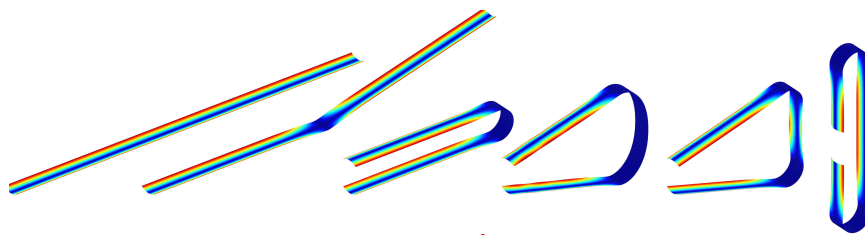
FIGURE 1.11 – Simulation de la déformation d’un mètre ruban avec un modèle unidimensionnel (extrait de (Guinot et al. , 2011)).
