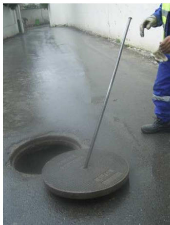
Mesures des taux d'encrassement dans les regards.
