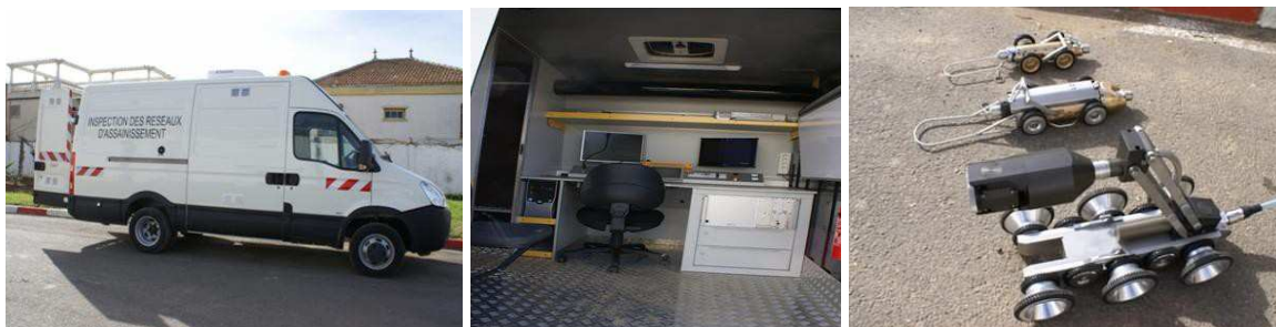
Le matériel utilisé dans les inspections TéléVisuelles (ITV)
