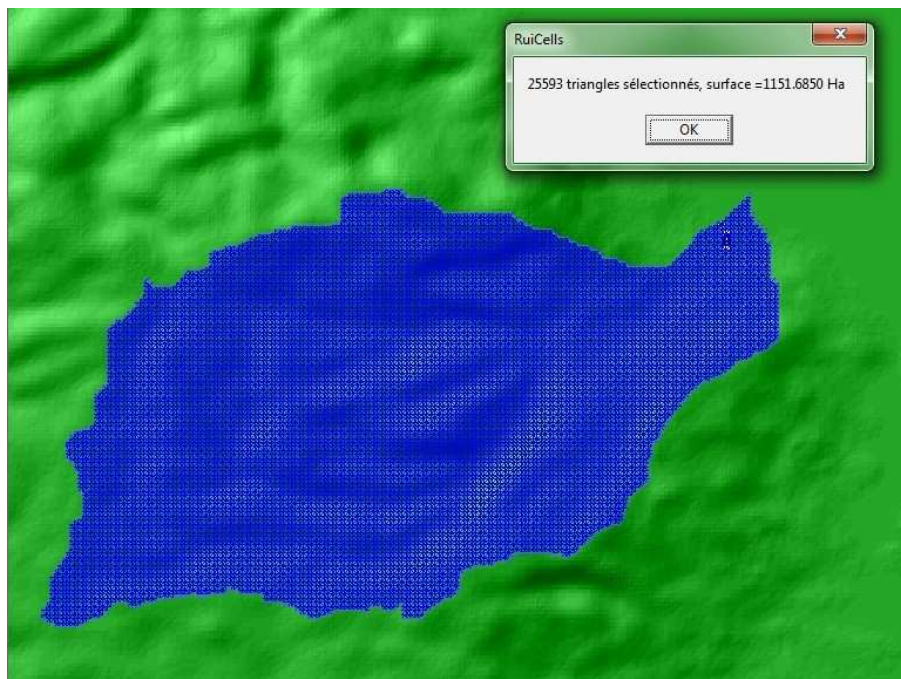
Fig. 6.11. Délimitation du bassin-versant de l'Oued Koriche et le calcul de sa surface.
