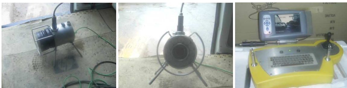
Le matériel utilisé dans les inspections VidéoPériscope.
