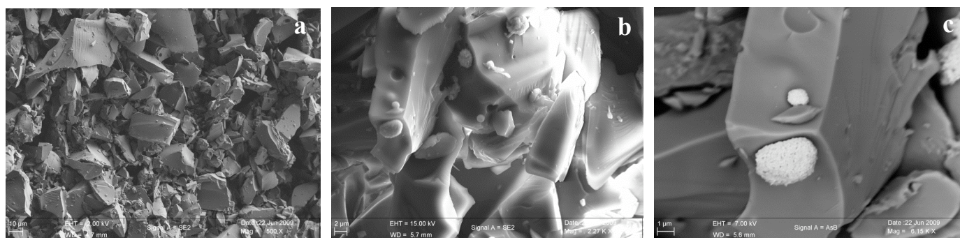
Figure 3.22: Images MEB de l'échantillon NBF67.18.5-R17 en mode électrons secondaires des grains de poudres à l'intérieur du fil chauffant après 5h à 820 K (a) grossissement *500 , (b) grossissement *2270 et (c) en mode rétrodiffusés, grossissement *6150, présence d'un "nodule" enrichi en Fe et O. Les échelles d'observations sont indiquées en bas à gauche des images.
