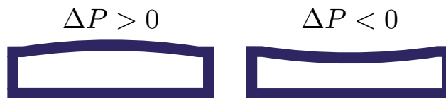
FIGURE 2.1: Sections schématiques d'un dispositif en PDMS. Le canal se gonfle lorsque la différence de pression imposée est positive alors qu'il se contracte si la différence de pression est négative.
