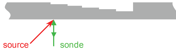
FIGURE 2.5 – Plaque de Duralumin présentant une série de 5 marches de 15 mm × 10 mm et de profondeur environ 0,1 mm.
