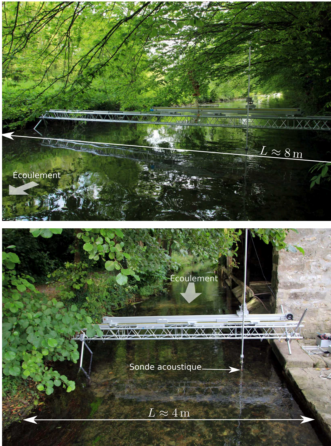
FIGURE 2.10 – Photos des deux tronçons sur lesquels ont été entrepris les mesures de vitesse. En haut, celui jouxtant la route du Moulin, dont la section, du côté gauche de l'image, est partiellement envasée. En bas, celui proche d'un lavoir du village de Dannemois, à la fin de la rue du Moulin à huile.
