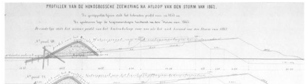
↑ Figures 11 à 13 : évolution des profils de digues imaginés au XIX e siècle. Source : Aten et al., 1997.
