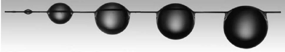
FIGURE 1.15 – Gouttes d’huile silicone de volumes  $\Omega = 0.01, 0.10, 0.23, 0.32$  et  $0.52 \mu\text{L}$ , accrochées à une fibre horizontale de rayon  $b = 12 \mu\text{m}$ . (Figure issue de [73].)
