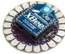
Imagen 90. Fotografía Xbee de Lylipad, emisión de señal inalámbrica
