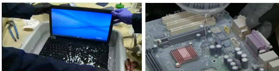
Imagen 31. Empresa Neverwet desarrolla propiedades hidrofobias no solamente en telas sino en circuitos y aparatos electrónicos.
