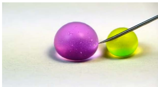
Imagen 30. Tela Hidrofóbica en acción. La no absorbencia no permite que las partículas de agua rompan su tensión superficial.
