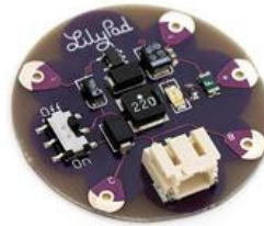
Imagen 53. Fotografía LiPower de Lylipad: conexión de fuente de energía para el mecanismo
