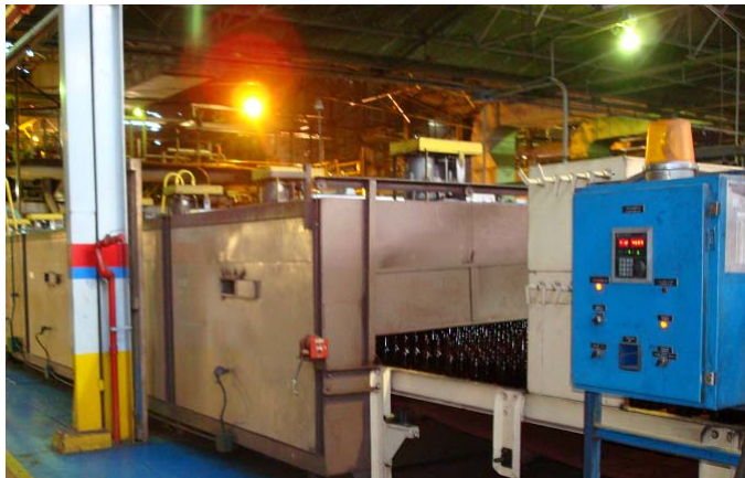
Figura 17. Vista de un archa de recocido O – I Peldar Planta Zipaquirá
