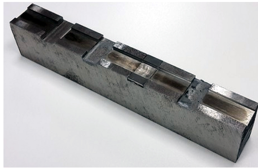
Abb. 6.3: Probekörper zum Test der Verbindungstechnik von Grundkörper und Inlay. Rechts: Durabond 954 (Inlay ausgebrochen), Mitte rechts: Weichlot Au-Sn, mitte links: Durabond 954 , links: kein Inlay
