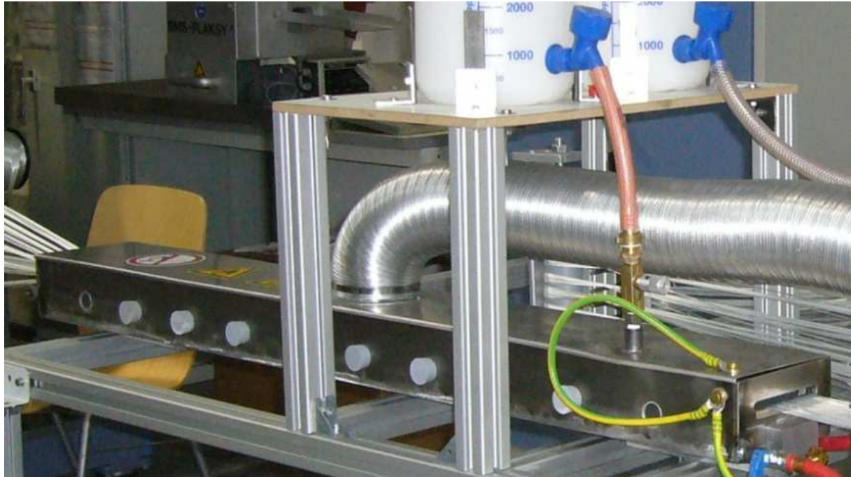
Abb. 6.5: Haftvermittler-Lösemittelbad zum kontinuierlichen Haftvermittlerauftrag
