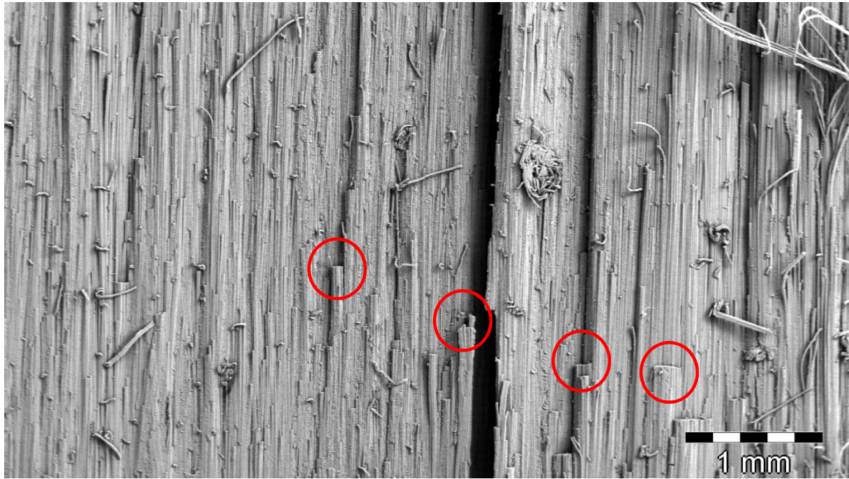
Abb. 7.15: REM-Aufnahme von RF-Anhydrid-EP mit 5g/l HV III und Faserbrüchen in der Scherebene
