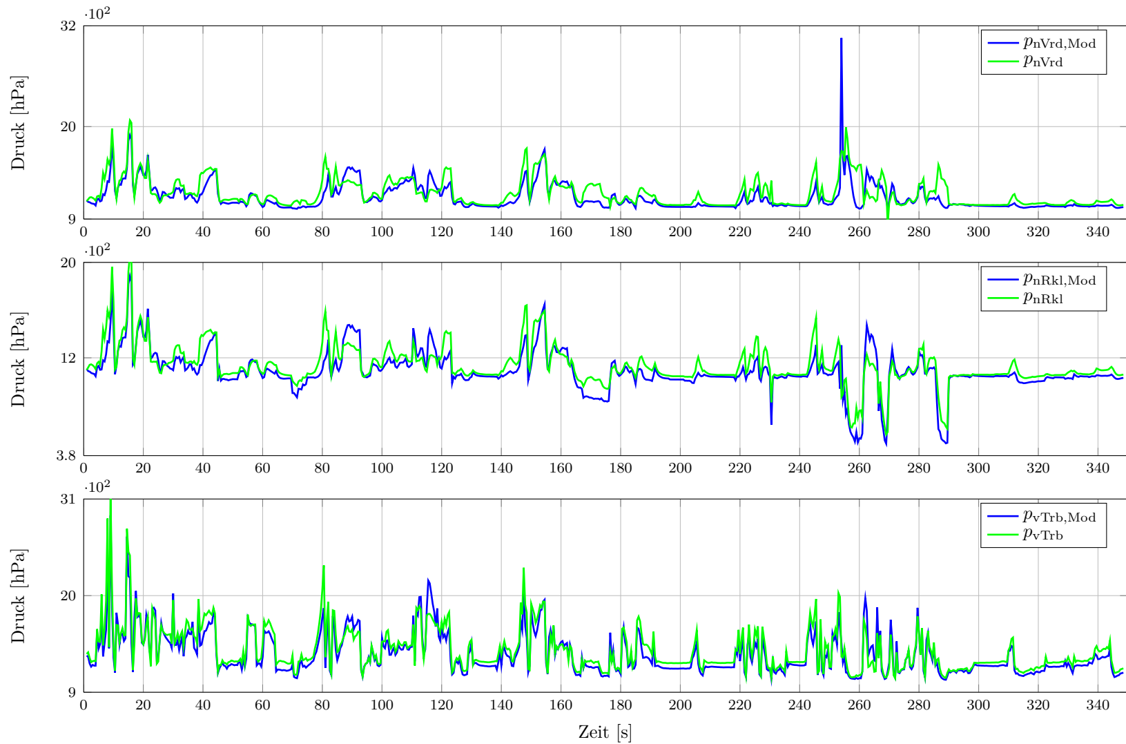
Abbildung 7.8: Simulation des dynamischen Modells mit dem Abgasturbolader. Dargestellt sind Messwerte in grün und Modellwerte in blau. Oben: Ladedruck. Mitte: Saugrohrdruck. Unten: Druck vor der Turbine.
