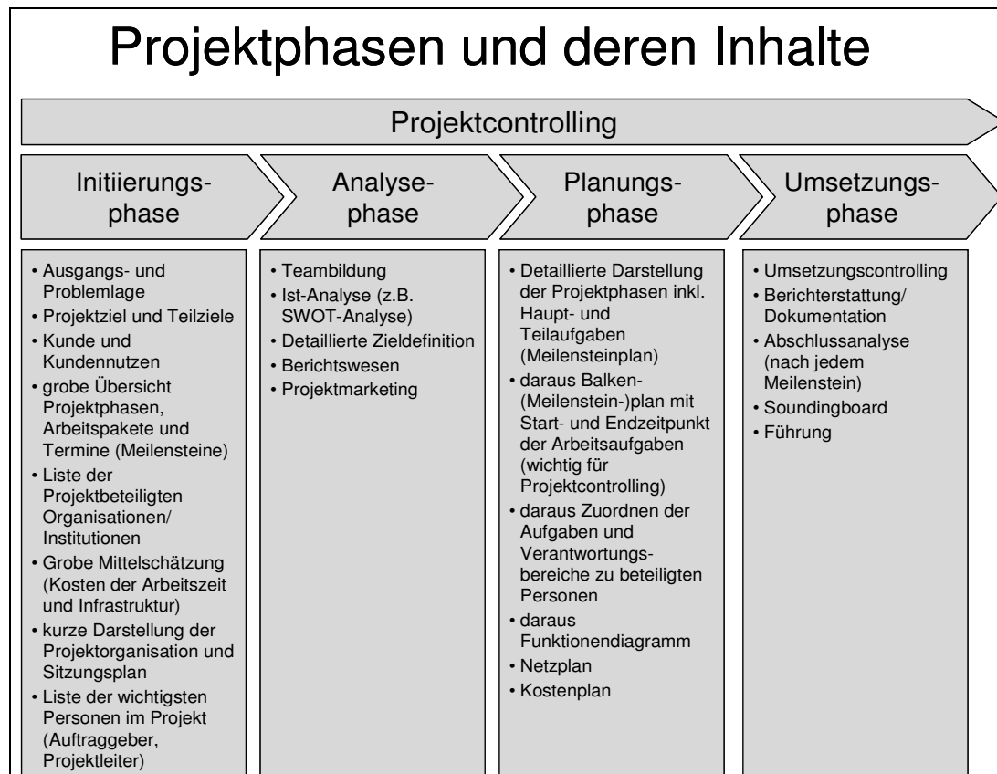
Bild I-10: Projektphasen und deren Inhalte (in Anlehnung an Hölzle/Grünig (2002, S. 56) und Stöger (2007, S. 35 f))
