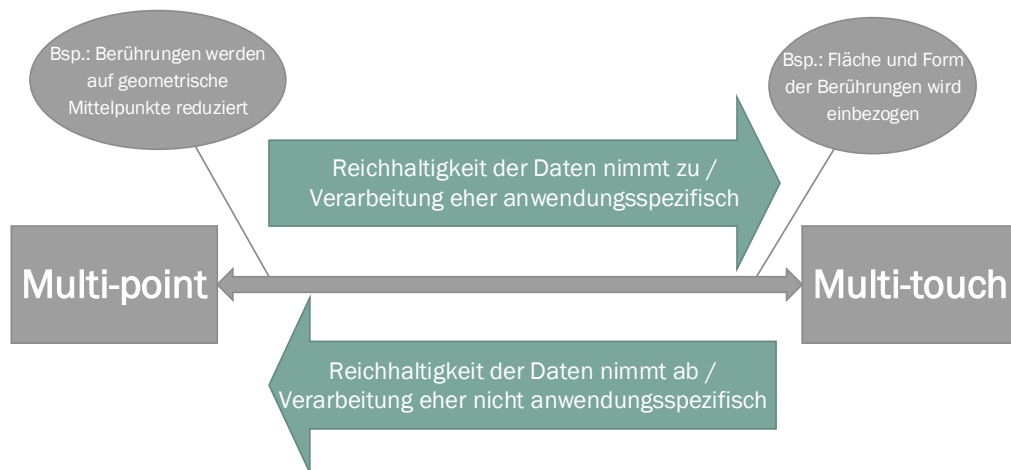
Abbildung 4.3: Schematische Darstellung zu der Gestaltungsdimension Multi-point vs. Multi-touch
