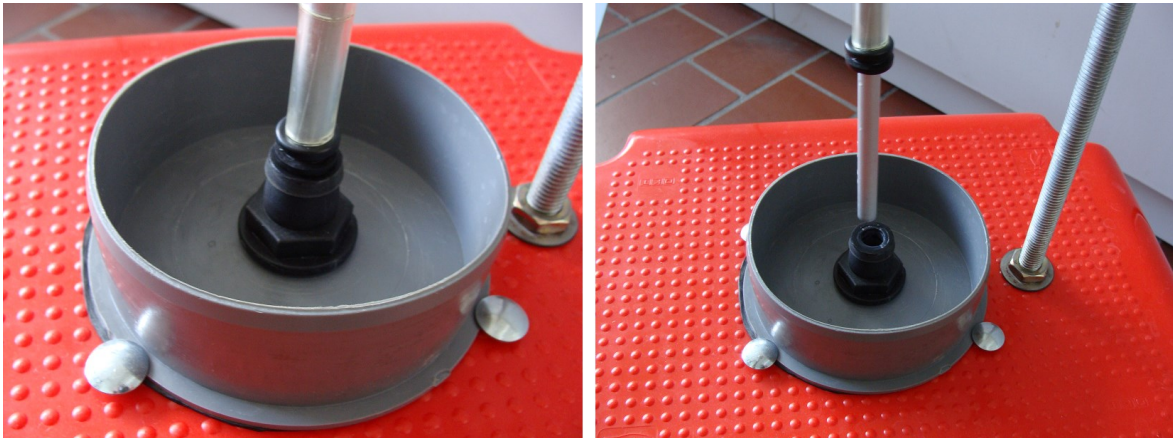
Abb. 7: Bodenstück des Absinkzylinders – Auffangbecken für den eingefüllten Sand und durch Stange verschlossener Ablassstutzen
