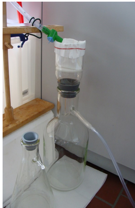
Abb. 21: Auffangbehälter (mit Filteraufsatz) für die aus dem Absinkzylinder abzulassende Wassersäule
