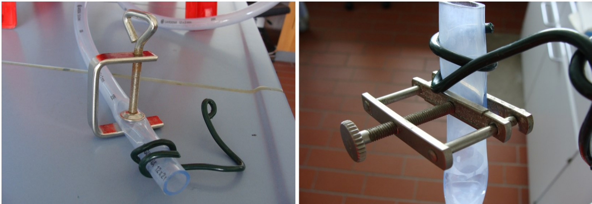
Abb. 9: Mögliche Verwendung von Schraubklemmen am Ende des Ablassschlauches (hier mit äußerem Haltedraht)
