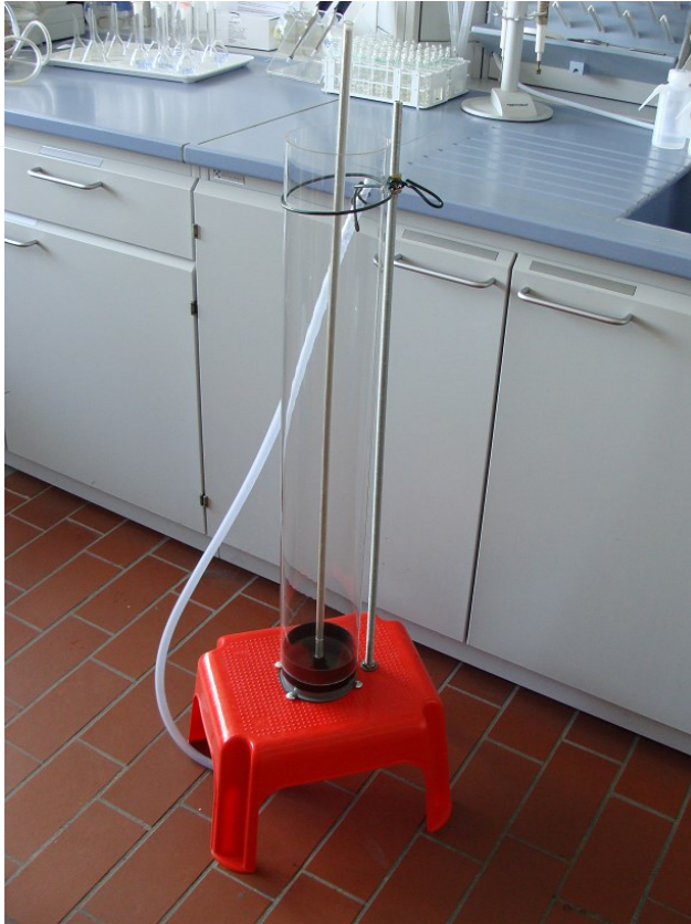
Abb. 6: Absinkzylinder – montiert auf abgedichtetem Bodenteil (mit eingesetzter Stange zum Verschluss des Abflusses) und Stabilisierungsstange rechts
