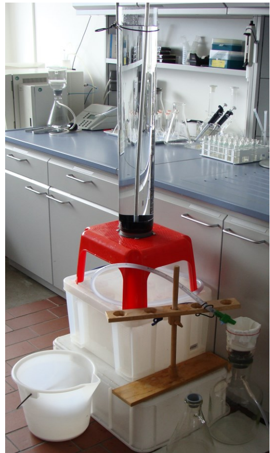
Abb. 10: Versuchsaufbau mit grün-blauem Ablasshahn und Filtrationssystem
