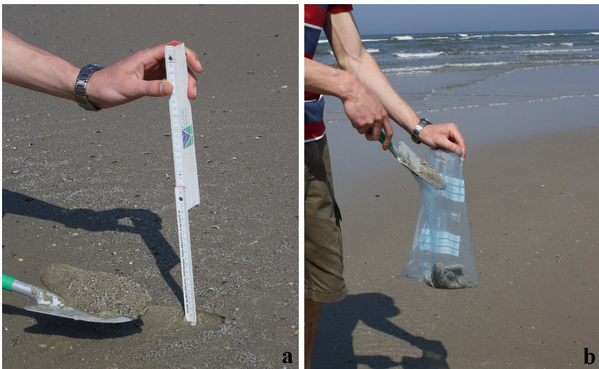
Abb.13: Probennahme am Spülsaum der Flutmarke: a) Aushub mittels Metallschaufel; b) vorsichtiges Einfüllen in reißfeste Frischhalte-Beutel
