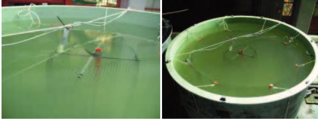
Abb. 1.4.31: Aufsicht in das Becken V (2,5 m Durchmesser) mit der Kathode (Drahtmatrix) am Außenrand des Beckens (Bild links) und Aufsicht mit innen liegender Anode (rechts).
