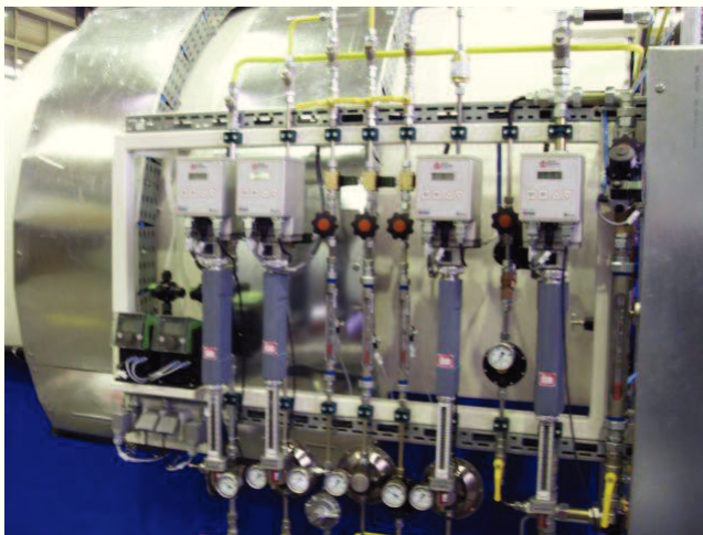
Aufbau der Begasung mit Massendurchflussreglern zur kontrollierten Einspeisung einer chargenangepassten Prozessmedienmenge
