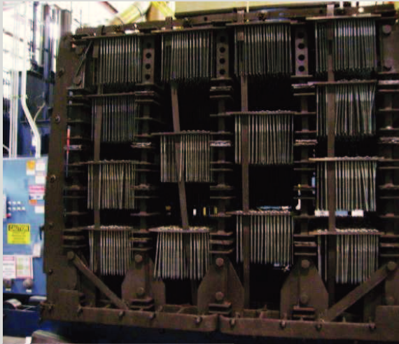
Stahlgestell Gewicht 485 KG; Teile Gewicht 190 KG
