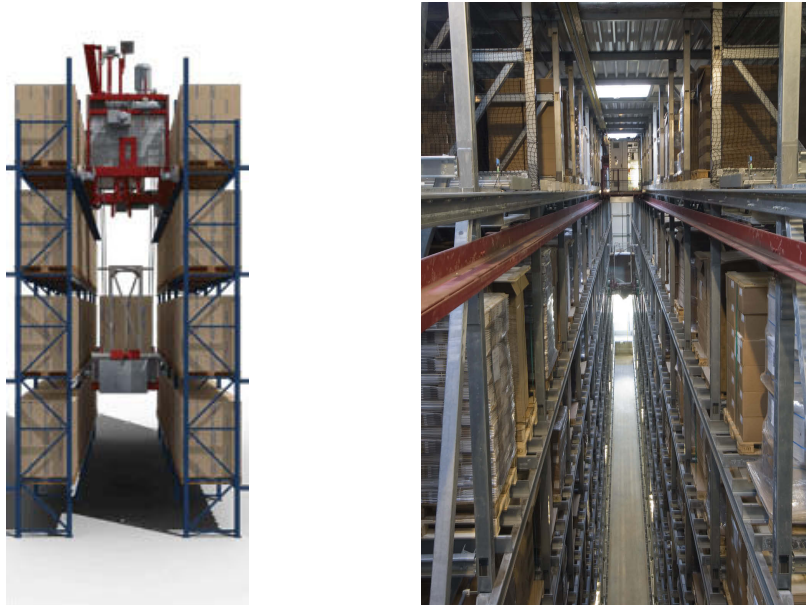
Abbildung 2.1: Einblick in die Regalgasse mit einer Laufkatze 1
