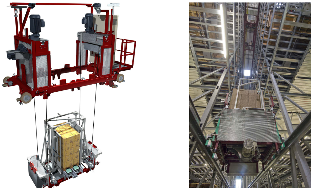
Abbildung 2.2: Aufbau des Laufkatzensystems Aviator TM 4
