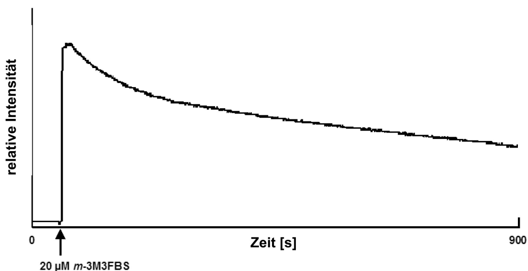
Abb. 3.6e: Eigenfluoreszenz von m-3M3FBS. Dargestellt ist die resultierende Änderung der Fluoreszenzintensität bei 340 nm nach Zugabe von 20 \mu\text{M} m-3M3FBS zu 2 mL bidestilliertem Wasser. Die Abnahme der Fluoreszenzintensität über die Zeit, kann dem UV-bedingten Zerfall des PLC-Aktivators m-3M3FBS zugeschrieben werden. Die dargestellte Messung ist exemplarisch für mindestens drei, voneinander unabhängig, durchgeführte Versuche.
