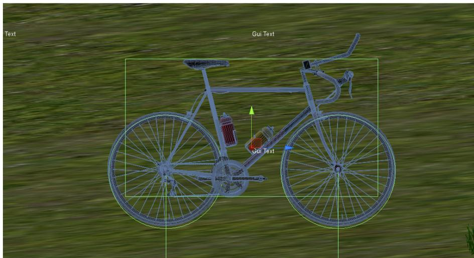
**Abbildung 6.12.:** Die Wheel Collider wurden exact in unser 3D-Modell eingefügt. Die beiden vertikalen Striche unter den Rädern zeigen die Stärke unserer Stoßdämpfer, und das Rechteck um das Fahrrad ist unser Box Collider. Dieser ist für Kollisionen zuständig
